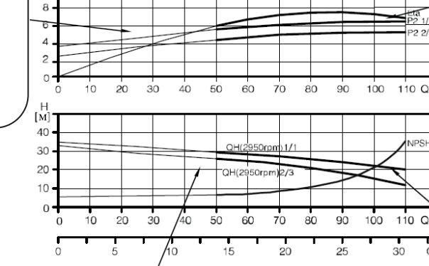
кривая ETA показывает КПД насоса с обычными колесами. КПД насосов уменьшенного диаметра примерно на 2% ниже, чем эта-кривая, показанная на графике.
