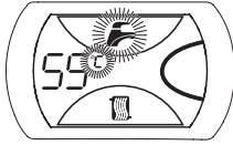
Рис. 5 Индикация настройки температуры ГВС
